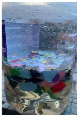
**Figura 12:** Despolpamento das fibras de papel. Fonte: Autor.
