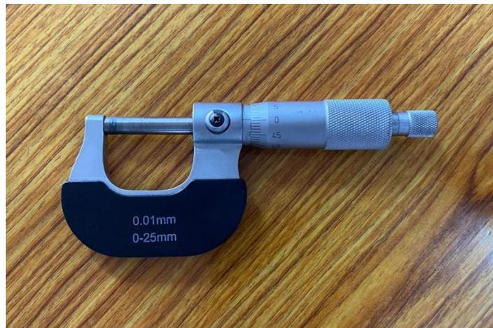
**Figura 17:** Micrómetro. Fonte: Autor
