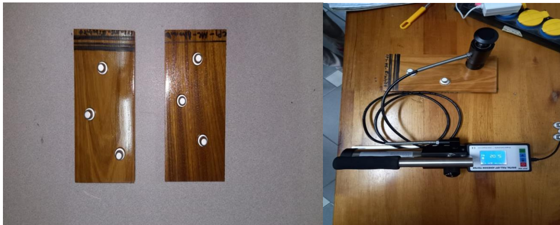
Figura 1: Amostras de madeira de Brachystegia spiciformis lado esquerdo, equipamento de ensaio a aderência a direita.
