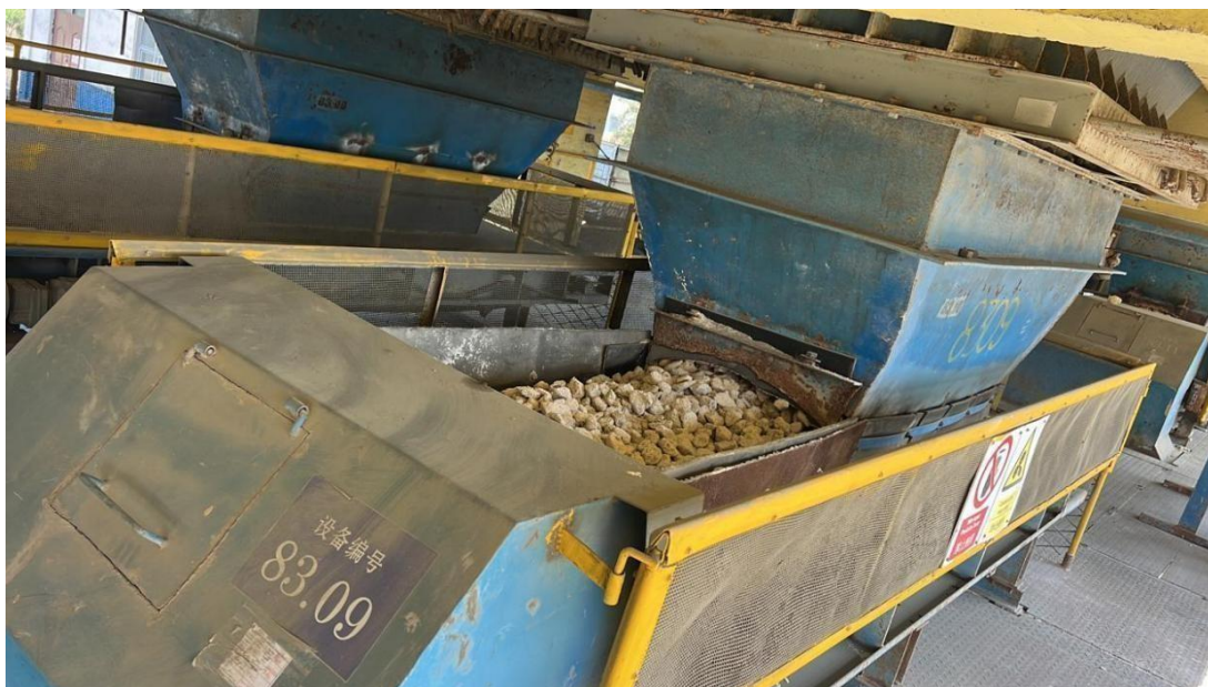
Figura 31: Máquina de estação de dosagem de matéria prima (Fonte:Autor)
