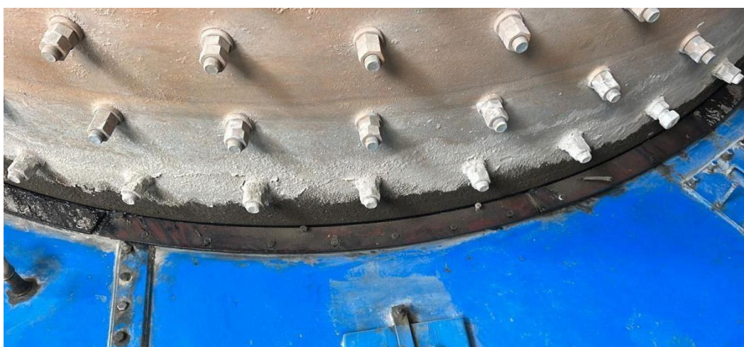
Figura 34: Parafusos que seguram os componentes do moinho (Fonte:Autor)
