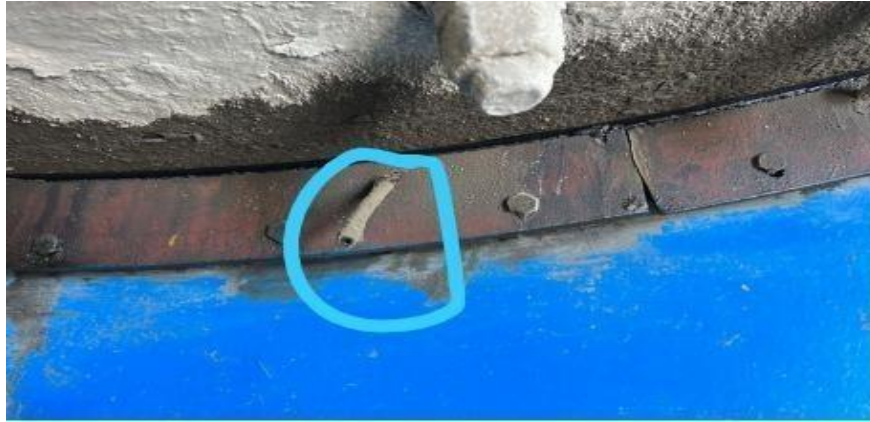
Figura 29: Tubo de entrada de lubrificação feito de forma manual (Fonte: Autor)
