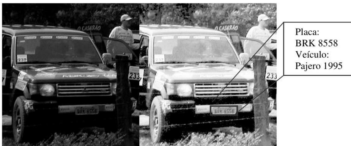
*Figura 5. Veículo em imagem escura (esquerda). Após uma equalização de histograma, em nível de cinza, onde a placa do veículo pode ser lida (direita). Fonte : (Marengoni & Stringhini, 2009)*
