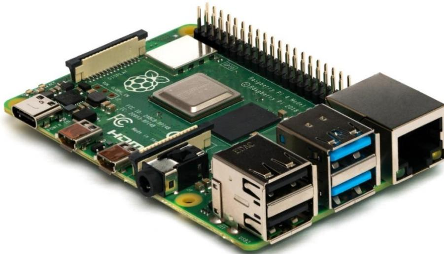
Figura 6 – Raspberry Pi 4. Fonte: (“Raspberry Pi,” 2024)
