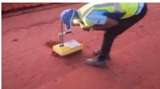
**Figura 3.8:** Controlo da densidade e teor de humidade.
