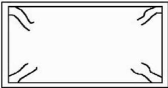
Figura 5. Fissuração por deficiência de armaduras para combate aos momentos volventes, na face da laje
