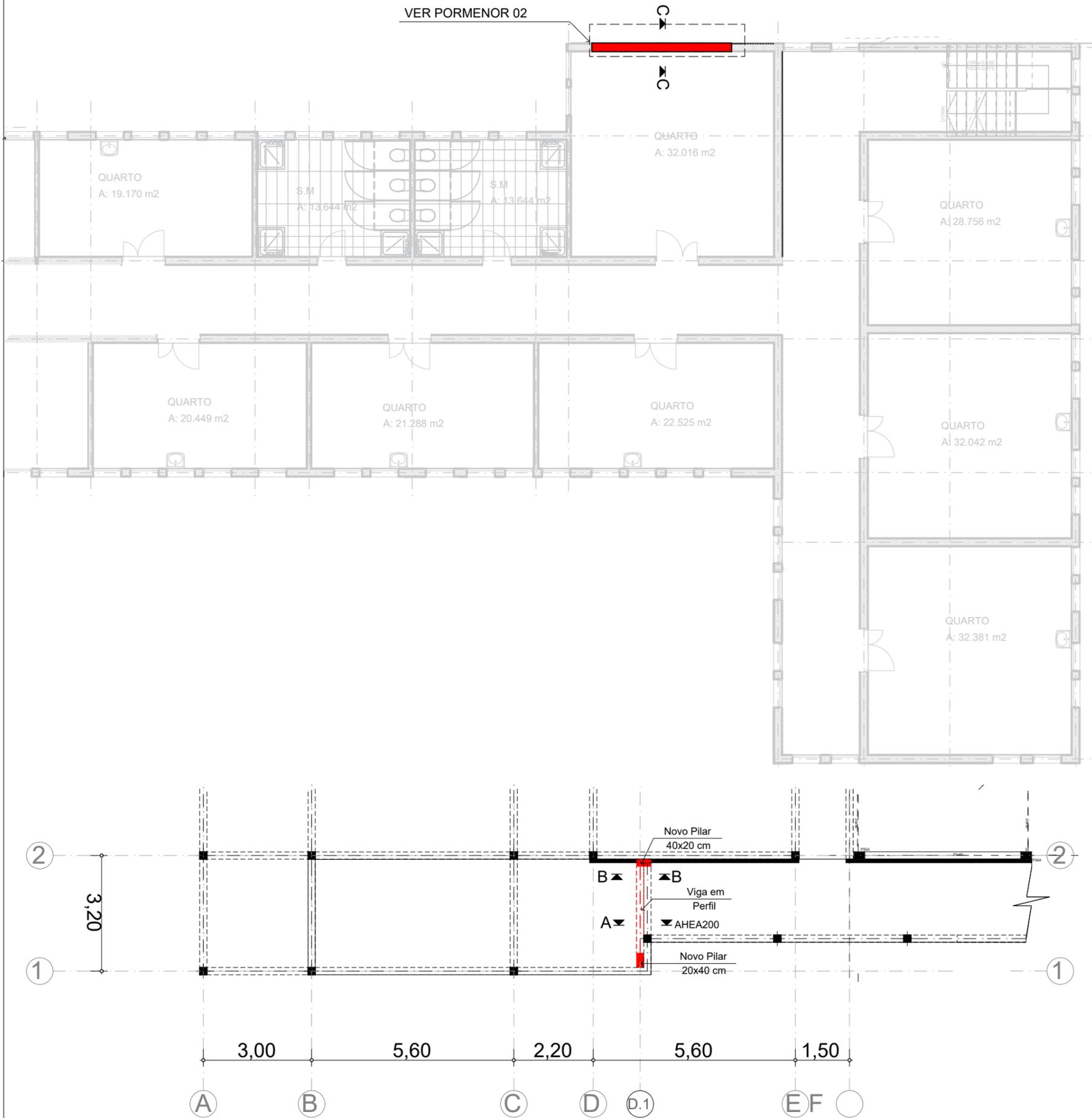
Planta de Cobertura com Indicação da Zona de Apliação / Transição de lajes - Nível 3.2 - 3.8 m 1:120
