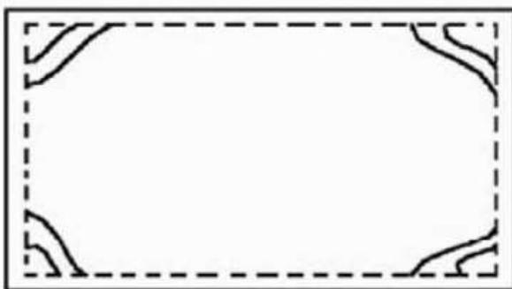
Figura 6. Fissuração por deficiência de armaduras para combate aos momentos volventes, na face superior da laje
