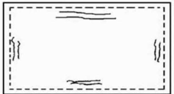
Figura 8. Fissuração de flexão, devida à insuficiência de armadura para momentos negativos. As fissuras surgem na face superior
