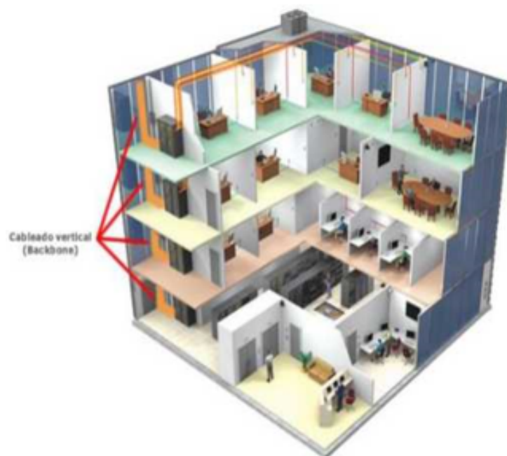
Figura 2.31: Fiação Vertical. Fonte: (PANDUIT, 2011)
