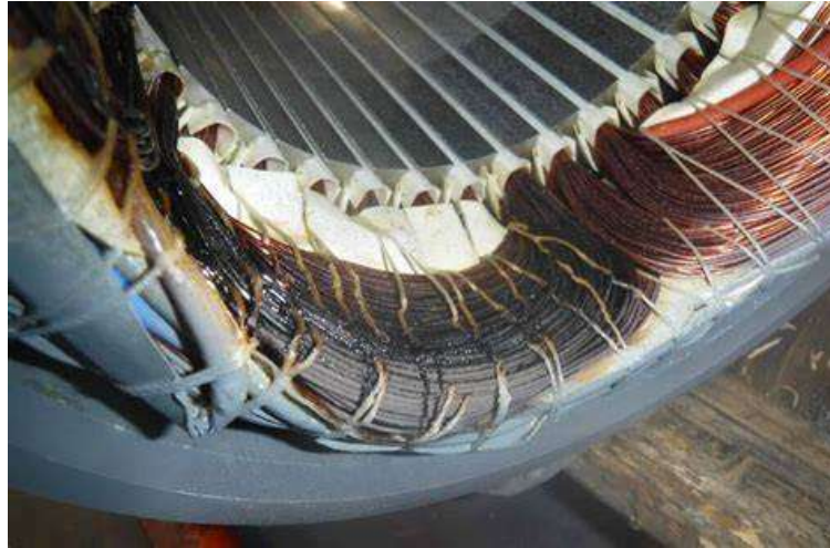
Figura 8: Motor queimado devido a sobretensões sustentadas
