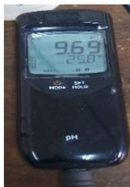
Figura 11: pHmetro digital (marca Hanna, modelo HI991001).
