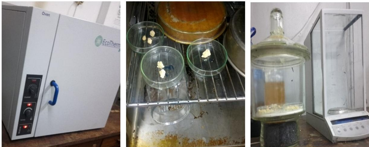
Figura 14: Secagem das amostras de sabão na estufa, precedido pelo arrefecimento em um dessecador para a pesagem final e cálculo da humidade.
